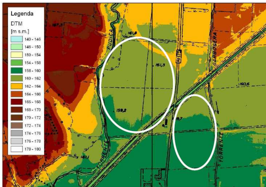
Figura 25 - Modello digitale del terreno nella zona di intervento. L'immagine evidenzia in maniera netta il terrazzo rialzato in sponda destra del torrente Pudiga.
